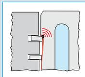
Werden neue Kolben und Kolbenringe in einen verschlissenen Zylinder eingebaut kommt es oftmals zu einem Anschlagen der Kolbenringe an der oberen Verschleißkante des Zylinders. Dadurch kommen die Kolbenringe ins Flattern und können nicht mehr richtig abdichten.
