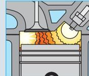
Durch klopfende Verbrennungen oder Glühzündungen kommt es zu großen Drucksitzen im Zylinder und hoher mechanischer Belastung der Teile. Die Kolbenringe kommen ins Flattern und können brechen. Bei Molybdänbeschichteten Ringen kann die Molybdänbeschicht ausbrechen.
