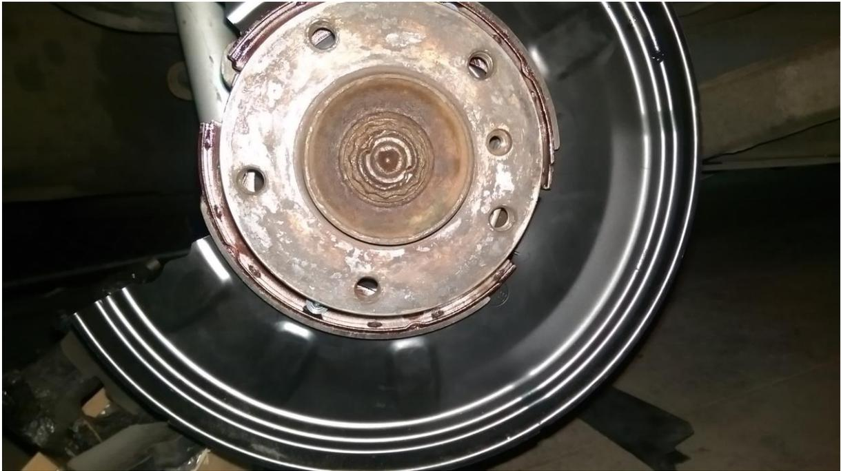
Da nun die Handbremse eingebaut ist geht es in den Endspurt. Der alte Bremssattel wird wieder von der Bremsleitung getrennt und der neue Sattel kann direkt an die Leitung angeschlossen werden, als nächstes wird die neue Bremsscheibe und der neue Bremssattelhalter montiert. Die Beläge einsetzen und Bremssattel einsetzen. Die Handbremse kann nun mittels verstell Rad eingestellt werden.
