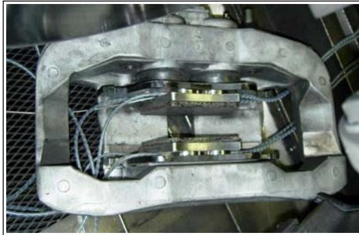
Abb. 13: iPads im Bremssattel (abgebildet ohne Stator)
