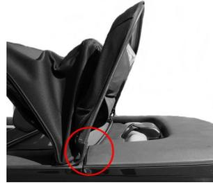
Im E36 Verdeckkompendium wird dieses Problem mit Hilfe von runden Spanngummis beschrieben. Diese Lösung hinterlässt aber einen Abdruck im Stoff bei den Spriegeln da dieses Gummi eben rund ist.
